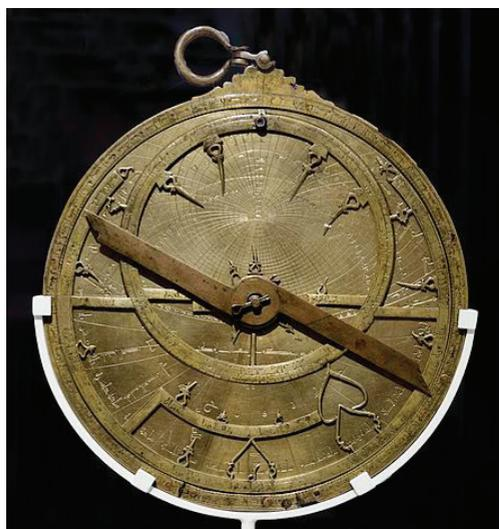
**Figura 31:** El astrolabio de *As Sahlī*, es un instrumento que permite determinar las posiciones de las estrellas, una herramienta que hizo posible la navegación marítima. Fue inventado por el musulmán *Ibrahim ibn Said al Sahlī* en 1066. Esta pieza se exhibe en el Museo Arqueológico Nacional en Madrid<sup>61</sup>.
